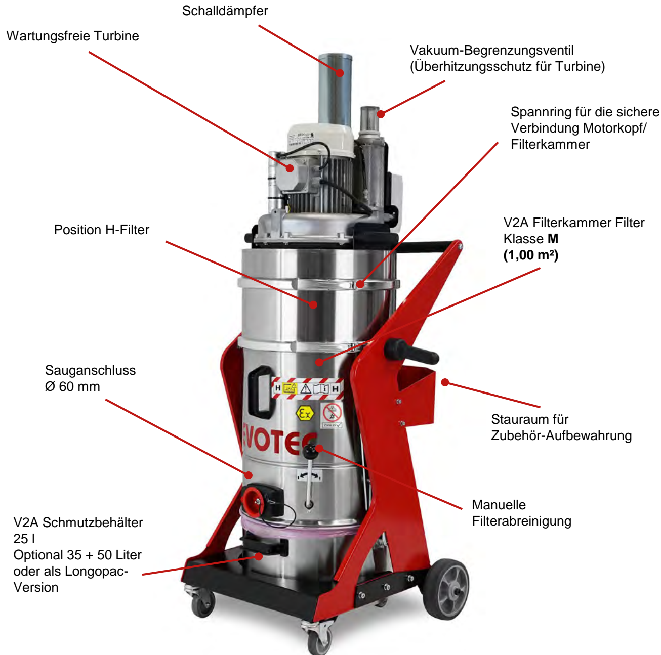
ECODustPro 15 mit Atmosphärendruck- abreinigung
