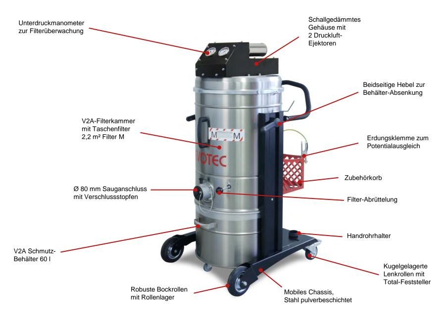
Leistungsstarker Druckluft-Trockensauger für das Saugen von sämtlichen trockenen Stäuben – von Grobschmutz bis hin zu Mikropartikeln (µm)
