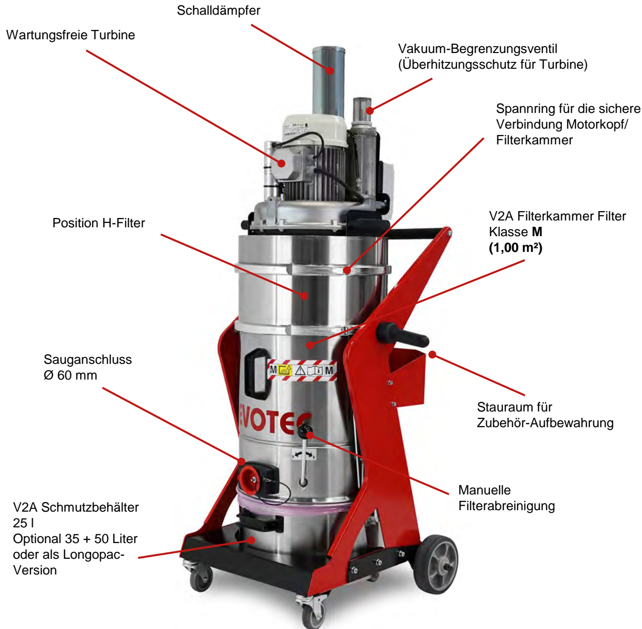
ECODustPro 15 mit Atmosphärendruck- abreinigung
