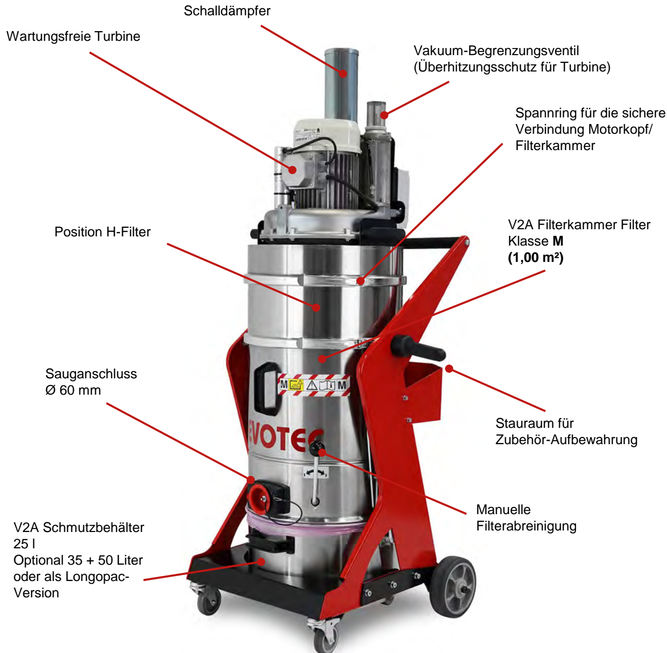
ECODustPro 15 mit Atmosphärendruck- abreinigung
