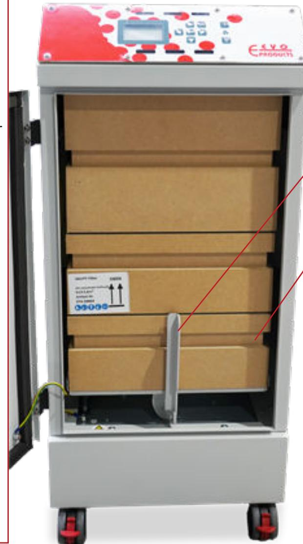
Leichtgängiger Hebel-Mechanismus zum Absenken der Filterkassetten - anschließend einfaches Herausziehen durch Griffnut und Schienensystem
